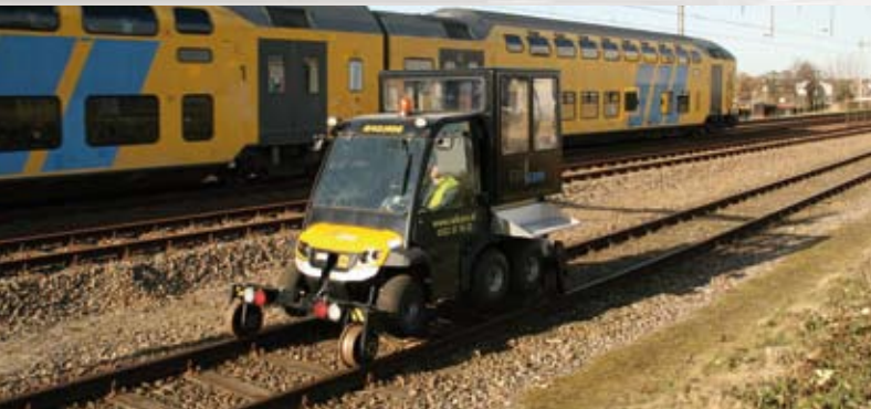
Railhog tijdens inspectie-werkzaamheden
